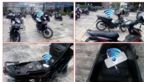
Gambar 8. Pemasangan Chip di Sepeda Motor
