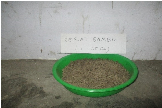
Gambar 4.6 Bahan campuran serat bambu
