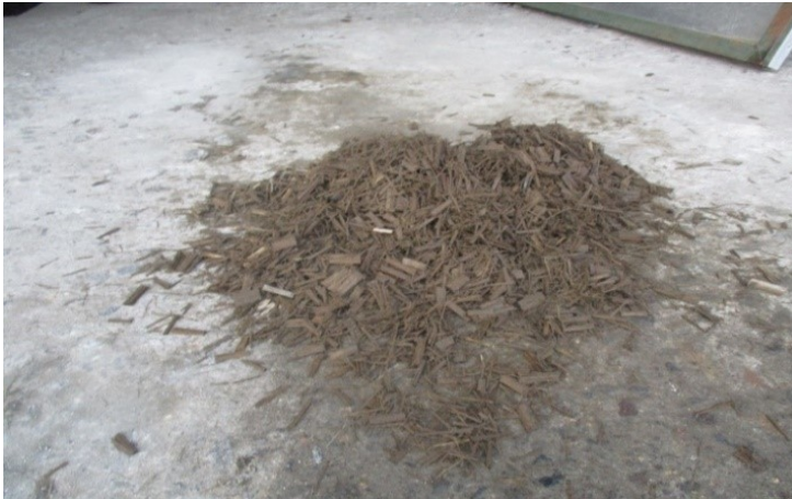
Gambar 4.4 Bambu yang telah ditumbuk dengan alat pematik
