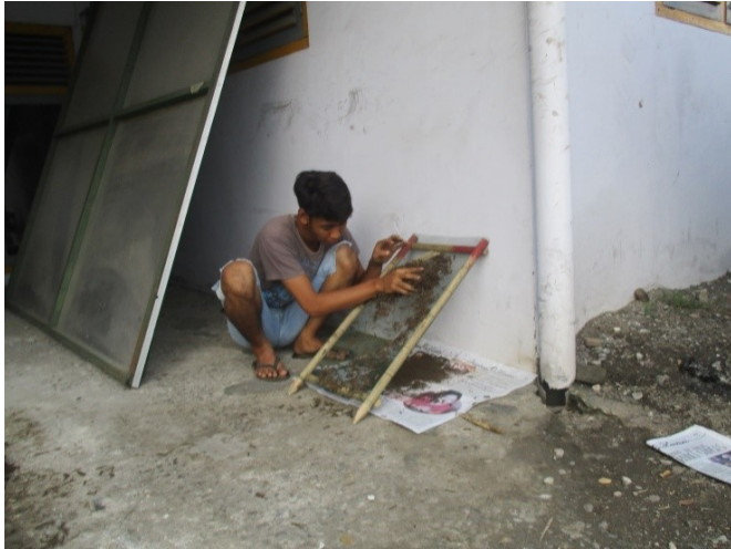
Gambar 4.5 Serat bambu yang diayak
