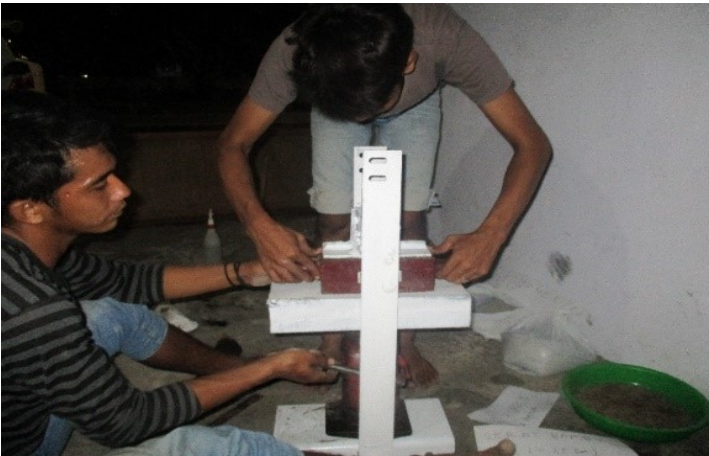
Gambar 4.11 Proses pembuatan paving block
