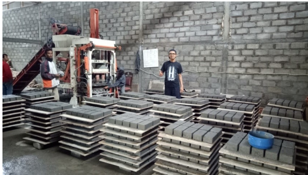
Gambar 8.18 Gudang proses produksi paving
