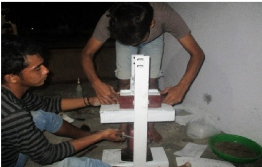
Gambar 4.11 Proses pembuatan paving block
