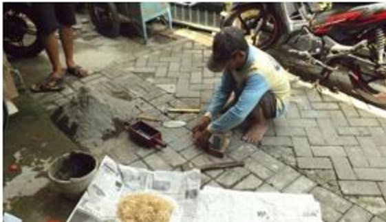
Gambar 6.1 Proses pembuatan Paving block dengan bamboo fiber
