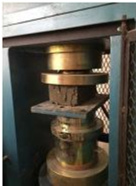
Gambar 7.3. Uji Tekan Paving
