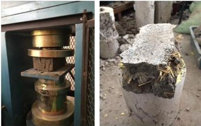
Gambar 6.5. Test Tekan dan Kerusakkan Paving
