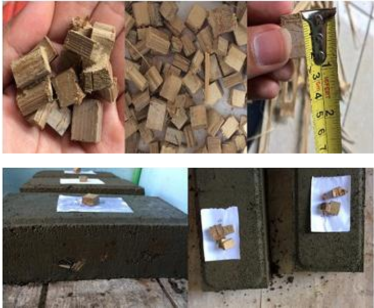
Gambar 6.6. Paving dengan material potongan bambu
