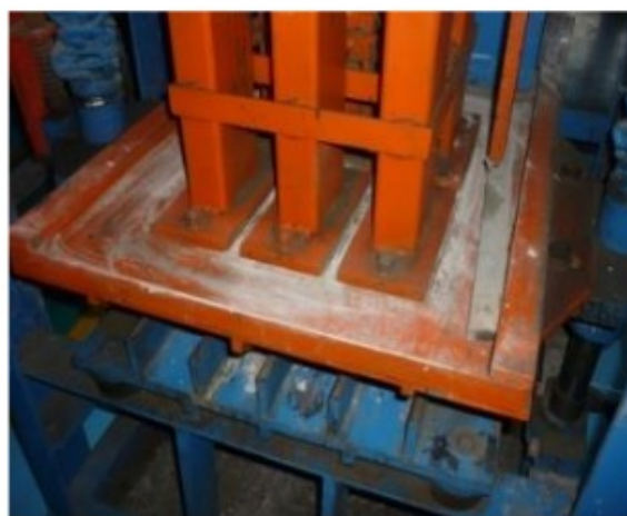
Gambar 7.4. Alat cetak paving ( Sumber : koleksi pribadi )
