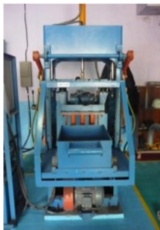
Gambar 7.4. Alat cetak paving ( Sumber : koleksi pribadi )
