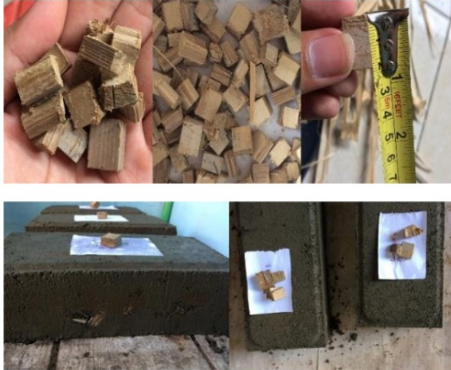
Gambar 6.6. Paving dengan material potongan bambu
