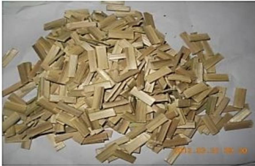
Gambar 1.4. Potongan Bambu uji coba 3mm x 15mm x 7mm setelah kering dari obat anti rayap (Sumber: Shakeel Ahmad, Altamash Raza, and Hina Gupta, 2014)
