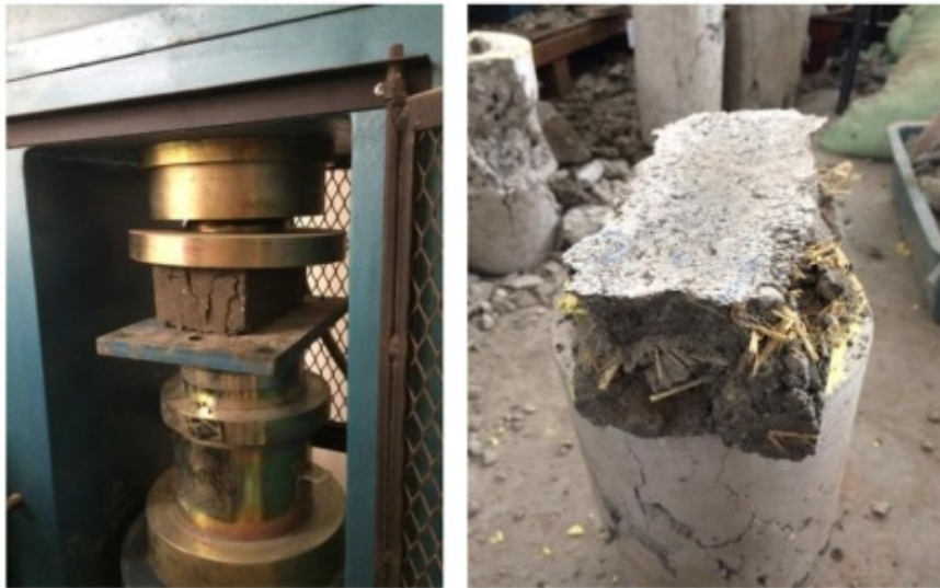
Gambar 6.5. Test Tekan dan Kerusakkan Paving
