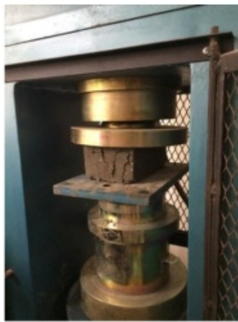
Gambar 7.3. Uji Tekan Paving
