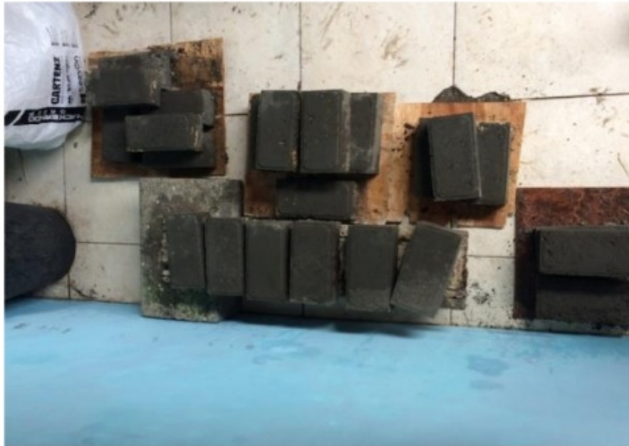
Gambar 6.3 Proses pembuatan Paving block selesai
