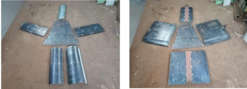
Gambar 6.1. Cetakan Precast Fondasi belum terangkai (Model Oval)
