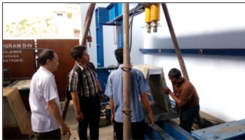
Gambar 7.1 Peletakan Fondasi Uji Tekan
