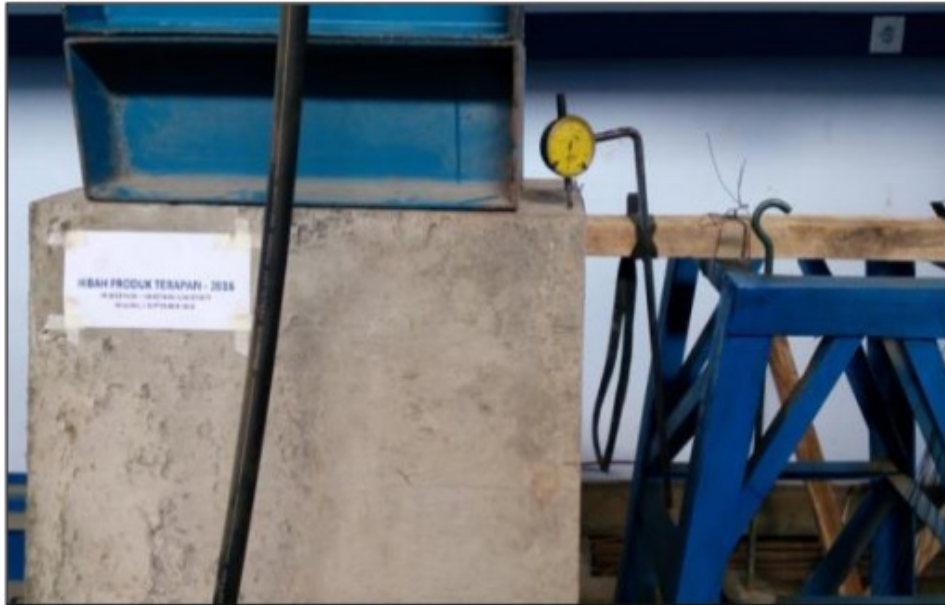
Gambar 7.2 Peletakan Dial Lendut
