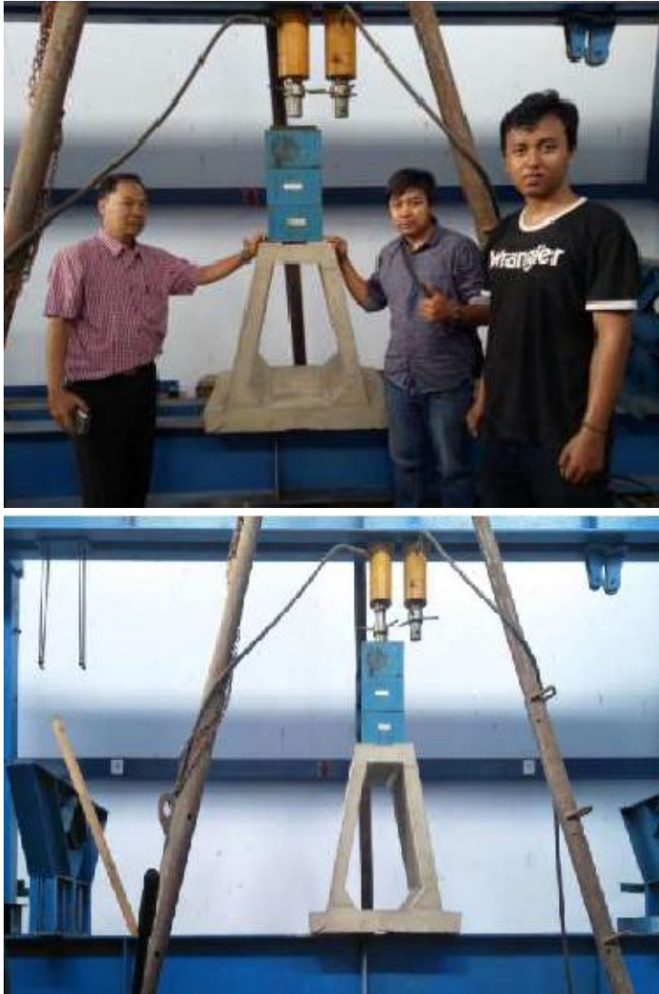
Gambar 4.14 Persiapan uji beban fondasi Precast
