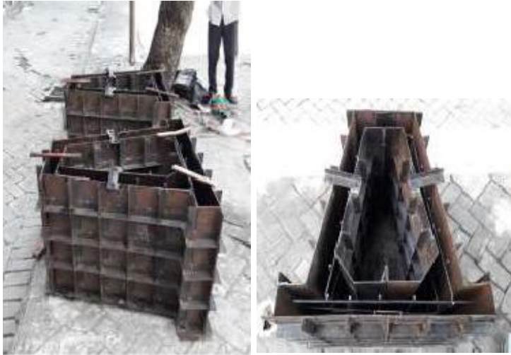
Gambar 4.1 Plat besi fondasi Precast
