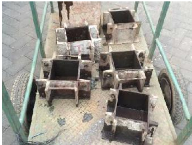
Gambar 3.6 Cetakan Kubus Sampel Beton
