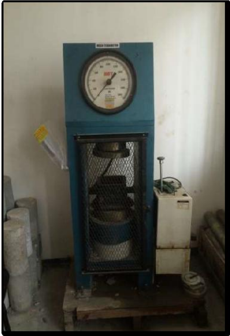
Gambar 3.2 Mesin Tes Tekan (Sumber : Lab. Sipil Narotama)
