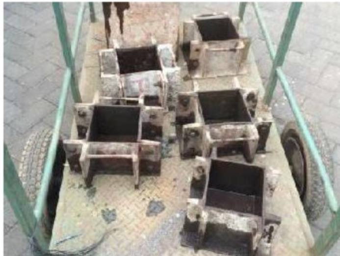
Gambar 3.6 Cetakan Kubus Sampel Beton
