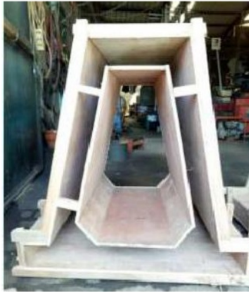
Gambar 3.15 Bekisting Fondasi Pracetak
