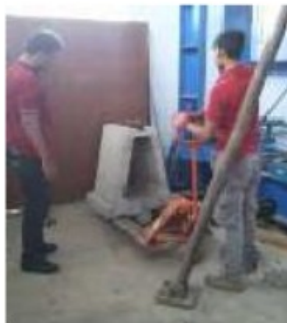
Gambar 4.12 Pengangkutan fondasi Precast untuk uji coba
