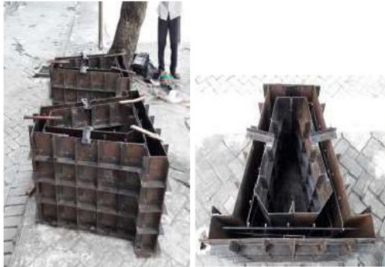
Gambar 4.1 Plat besi fondasi Precast
