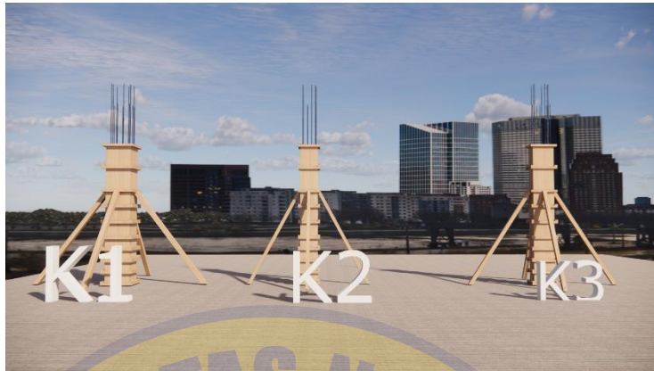
Gambar 4.1 Pemodelan 3D Kolom Bekisting Konvensional
