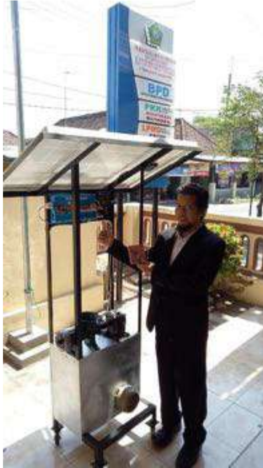
Gambar 5. Produk teknologi portable Fish Feeding Machine didukung rangka struktur besi dan energi terbarukan portable solarcell , Nelayan SUBUR Sejahtera dan MAKMUR Sejahtera desa Banjar Kemuning kecamatan Sedati kabupaten Sidoarjo
