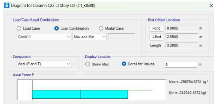
Gambar 4. 26 Gaya Axial kolom type C1 yang ditinjau Lantai 2, As (B,2)
