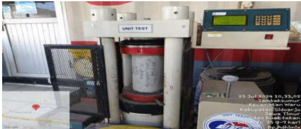
Gambar 4.6 tes kuat tekan beton
