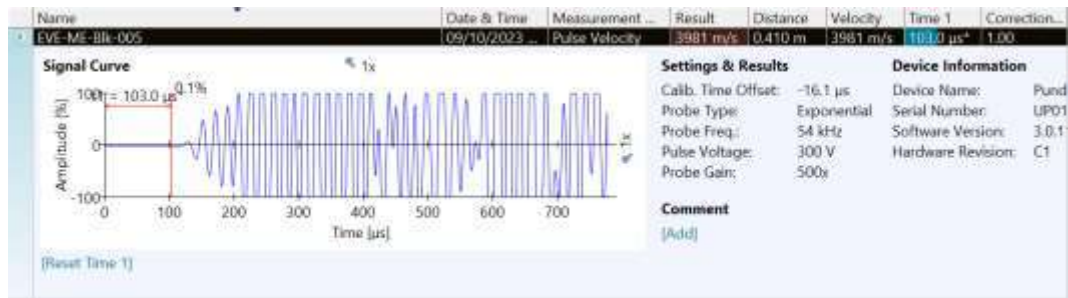
Gambar 4. 23 Hasil Grafik Pengujian UPV Direct Elemen Balok, V=3981 m/s (Good)
