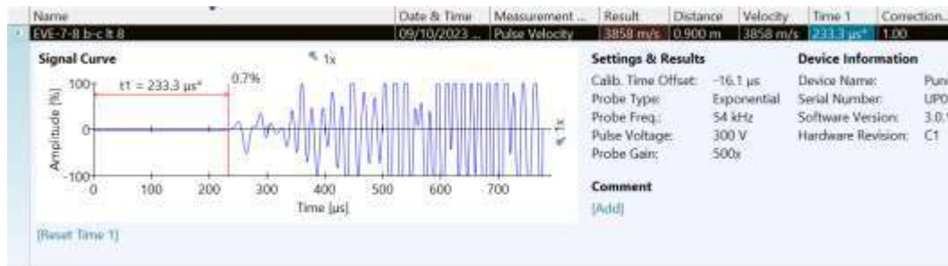
Gambar 4. 32 Hasil Grafik Pengujian UPV Direct Elemen Pelat, V=3857 m/s (Good)
