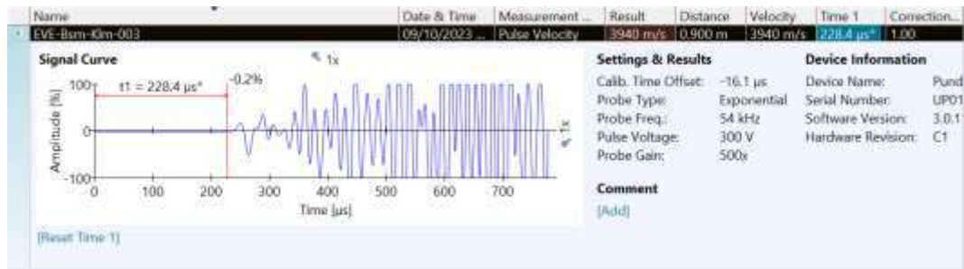
Gambar 4. 29 Hasil Grafik Pengujian UPV Direct Elemen Kolom, V=3940 m/s (Good)
