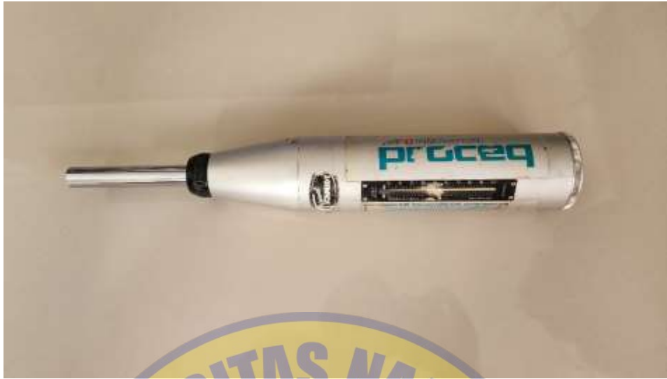
Gambar 2. 1. Original Schmidt N-34 dari PROCEQ
