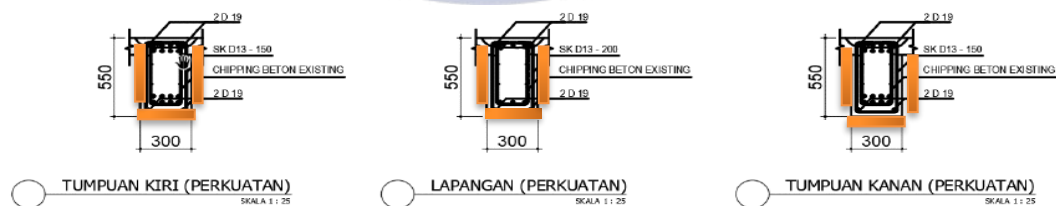
Gambar 4. 29 Permukaan Bekisting Balok Perkuatan
