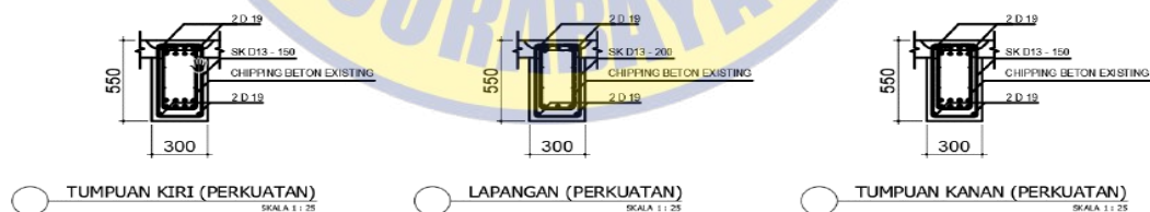
Gambar 4. 27 Tulangan Sengkang (Pembesian Balok)
