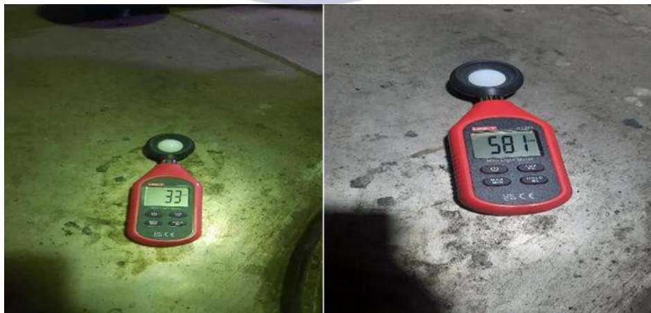
Gambar 4.1. Perbedaan intensitas cahaya lampu merkuri (kiri) dan lampu LED (Kanan)
