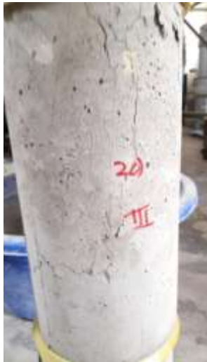
Kerusakan pada kode uji 20%
