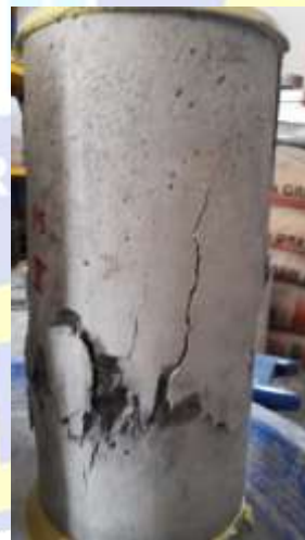
Kerusakan pada kode uji 15%
