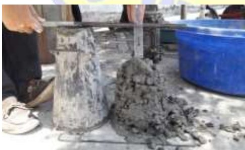
Tes slump Beton segar
