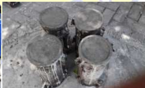
Beton segar dalam cetakan silinder
