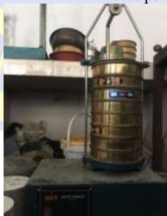
Tes saringan agregat
