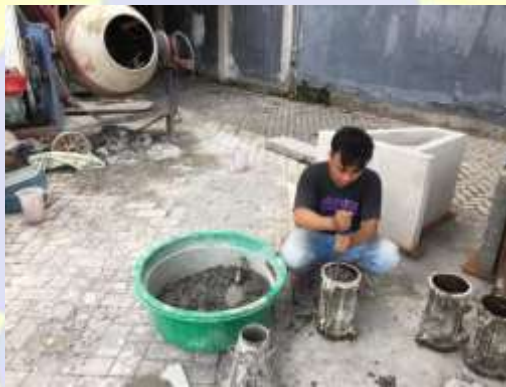
Proses memasukkan beton segar kedalam wadah silinder
