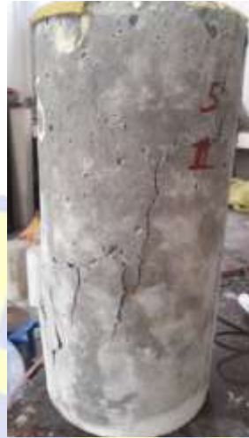
Kerusakan pada kode uji 5%
