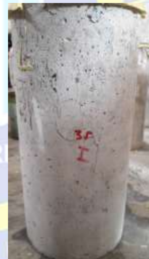
Kerusakan pada kode uji 35 %
