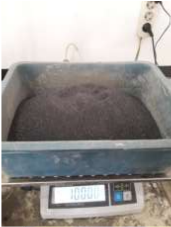
Proses penimbangan agregat halus
