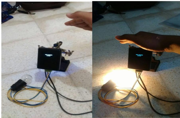
Gambar 8.4. Pengujian Sensor Cuaca (Modul LDR)
