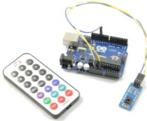
Gambar 5.4. Rangkaian Uji Infra Red dan Remote Control
