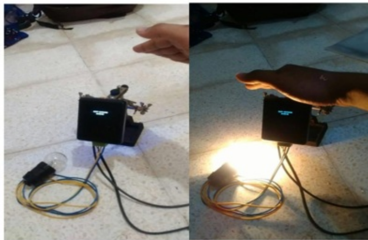
Gambar 8.4. Pengujian Sensor Cuaca (Modul LDR)
