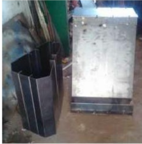
Gambar 3.22 Cetakan Bagian Dalam
