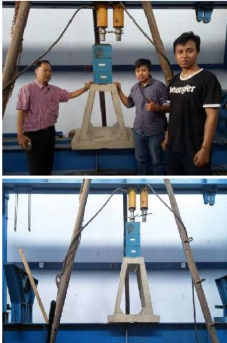
Gambar 4.14 Persiapan uji beban fondasi Precast
