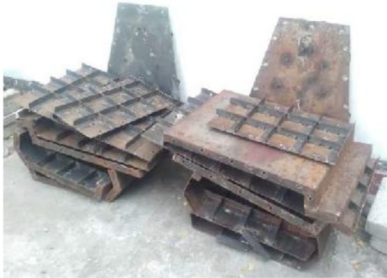
Gambar 3.23 Rangkaian Cetakan Precast
