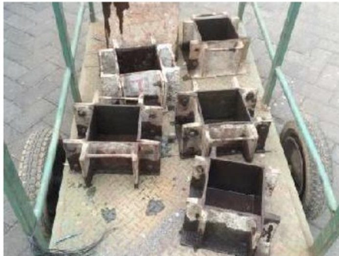
Gambar 3.6 Cetakan Kubus Sampel Beton
