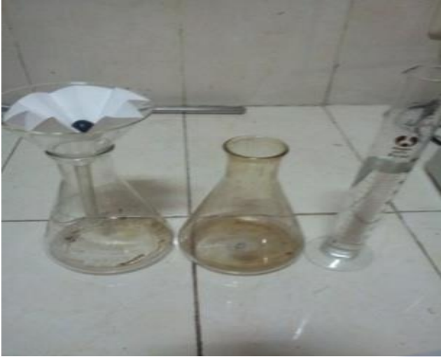
Gambar Alat pengujian kelarutan aspal dalam TCE
