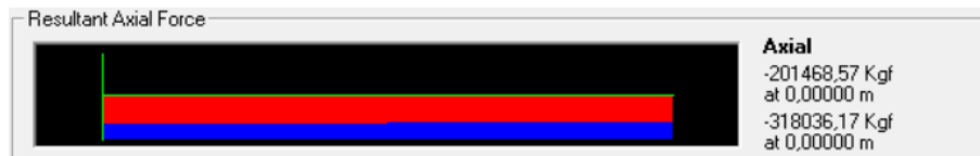
Gambar 6.9 Gaya Aksial Kolom pada SAP 2000 v.14
