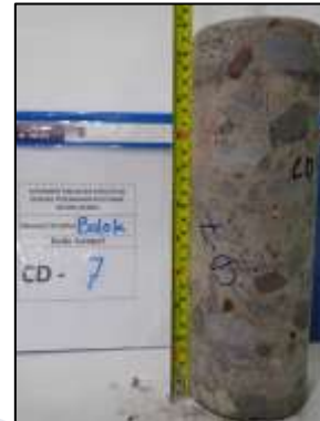
Gambar 4.59 Core Drill Sampling Beton CD-7 (Core Log) pada Balok
