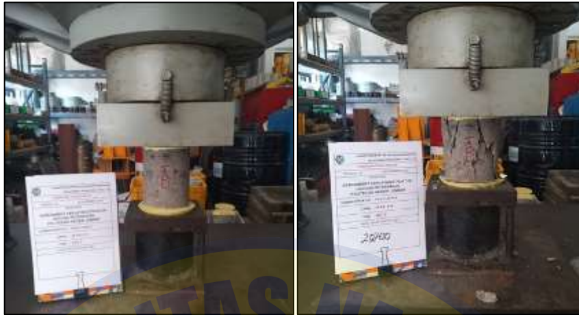
Gambar 4.62 Hasil Pengujian Kuat Tekan pada CD – 1 (Pelat)
