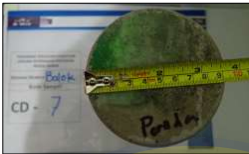
Gambar 4.59 Core Drill Sampling Beton CD-7 (Core Log) pada Balok
