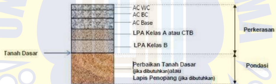
Gambar 2. 10. Struktur Perkerasan Lentur Pada Tanah Asli (Sumber: Dirjen Bina Marga, MDP 2017)
